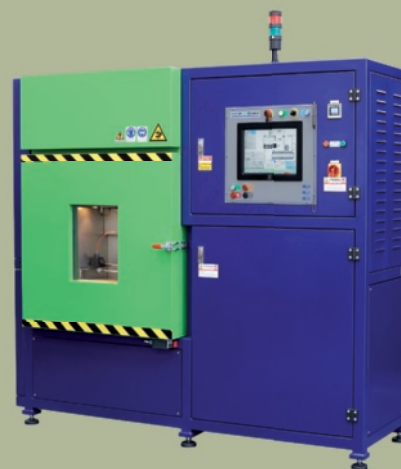
Fig. 1 – Banco di collaudo tubazioni per automotive
