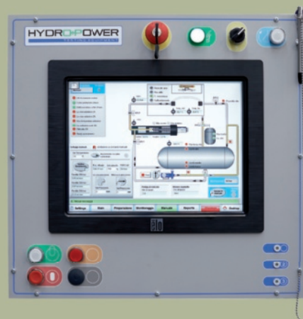
Fig. 2 – PLC del banco di collaudo tubazioni per automotive
